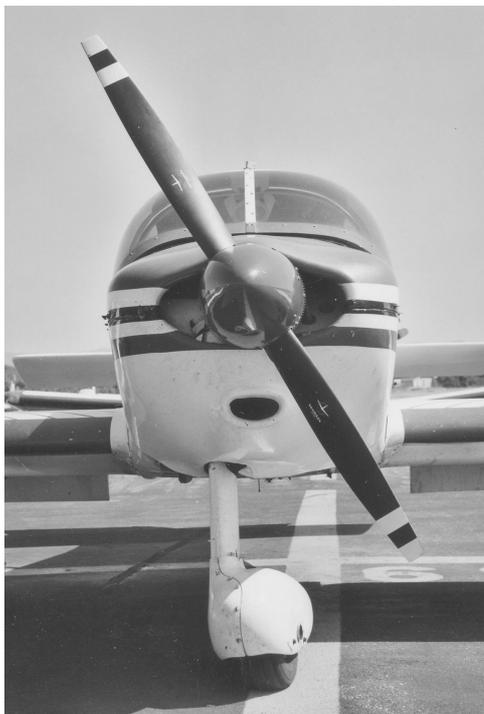
Ce type d'hélice équipe les appareils sur lesquels nous volons en général. Elle doit être surveillée à chaque visite pré vol et entretenue dans un très grand état de propreté. Les insectes et les poussières doivent être systématiquement éliminés à l'eau savonneuse et elle doit être essuyée à la peau de chamois. De sa surface lisse et propre dépend le bon rendement de l'avion.
