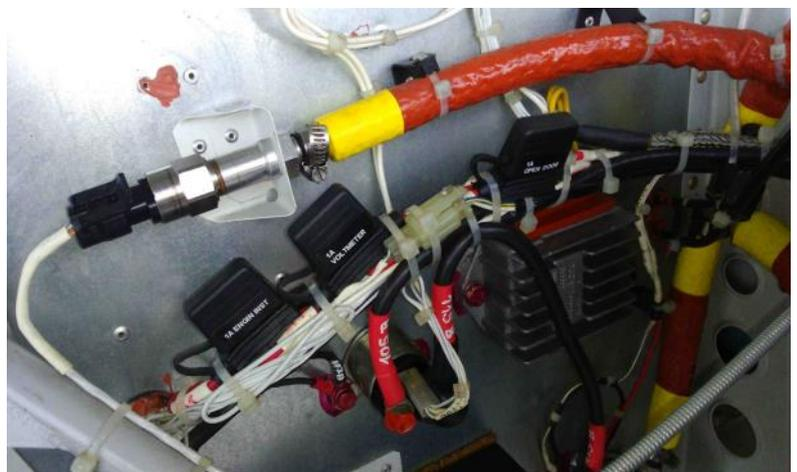
*les accessoires électriques au-dessus de la batterie, sur la cloison entre moteur et fuselage*
